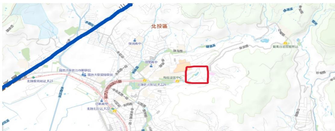
圖 2：地熱谷附近斷層示意圖。圖中藍線為山腳斷層，紅色方框為地熱谷
